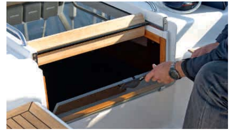
Immer vor Ort. Das flache Steckschott wird zum Öffnen heruntergeklappt
