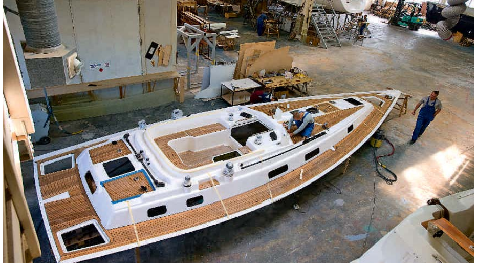
Inselfertigung auf der Insel. Saare Paat baut nicht am Fließband, sondern stationär. Das Deck der neuen Yacht wird komplett bestückt, bevor es auf den Rumpf kommt
