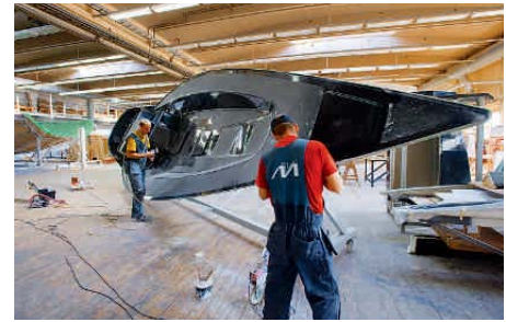
Gut in Form. Die Negativschale einer Finngulf 33 wird penibel vorbereitet
