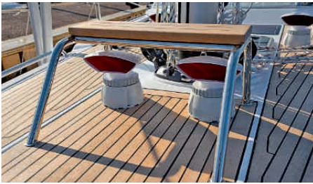
Gutes Detail. Der Hocker schützt die Lüfter und dient als Tritt oder Sitz
