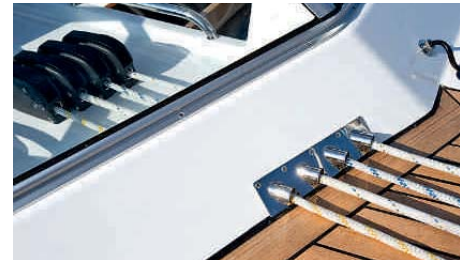
Guter Job. Die geschweißten Teile wie diese Leinendurchlässe sind perfekt
