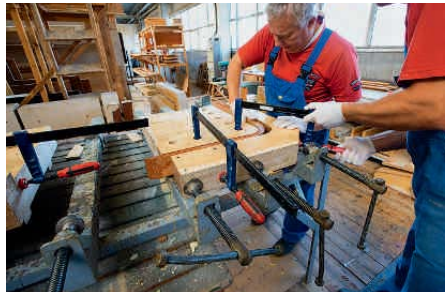
Viel Handarbeit. Hier werden Holzstreifen zu Abschlusskanten lamelliert
